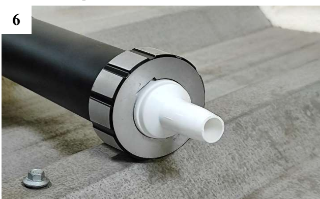
6 Encaixe o bico no aplicador
