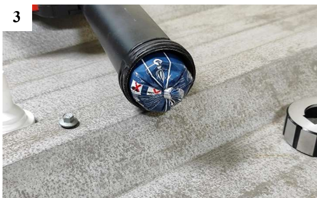
3 Posicione o sachê dentro do aplicador
